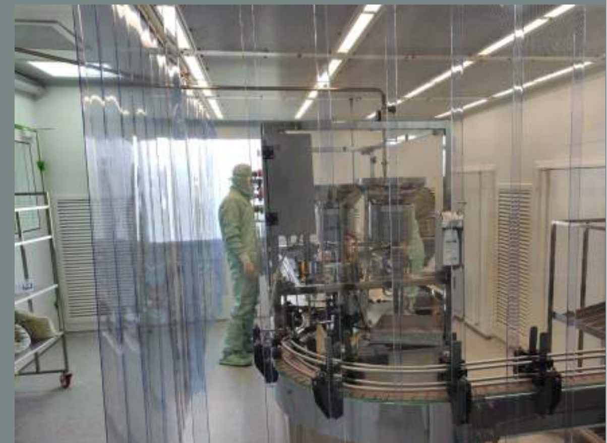
Лінія розливу рідких лікарських форм та інших не токсичних водних розчинів в пластикову тару 100-200 мл. Проектна потужність (річна) - 2 млн. пляшок.
