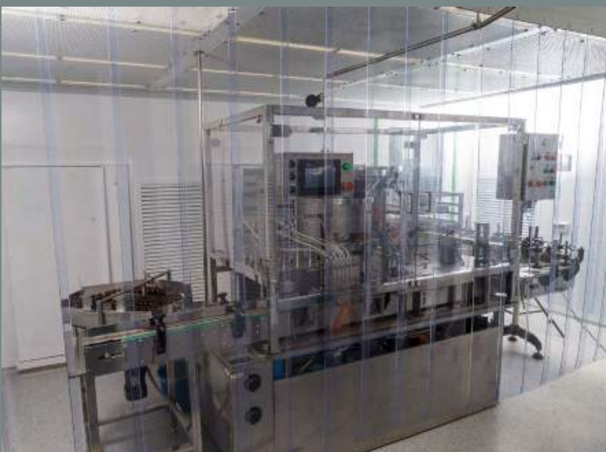
Лінія розливу рідких лікарських форм та інших не токсичних водних розчинів в пластикову тару 100-200 мл. Проектна потужність (річна) - 2 млн. пляшок.
